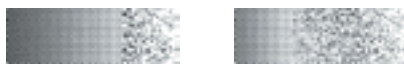
Преход от регулярного раstra и стохастическому. Слева — резкий переход от одного к другому, справа — плавный, полученный по технологии Nexus HybridScreening
