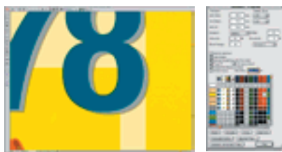
Окно Artpro Trapper и панель настроек параметров автоматического треппинга для каждого из цветов и типов графики
