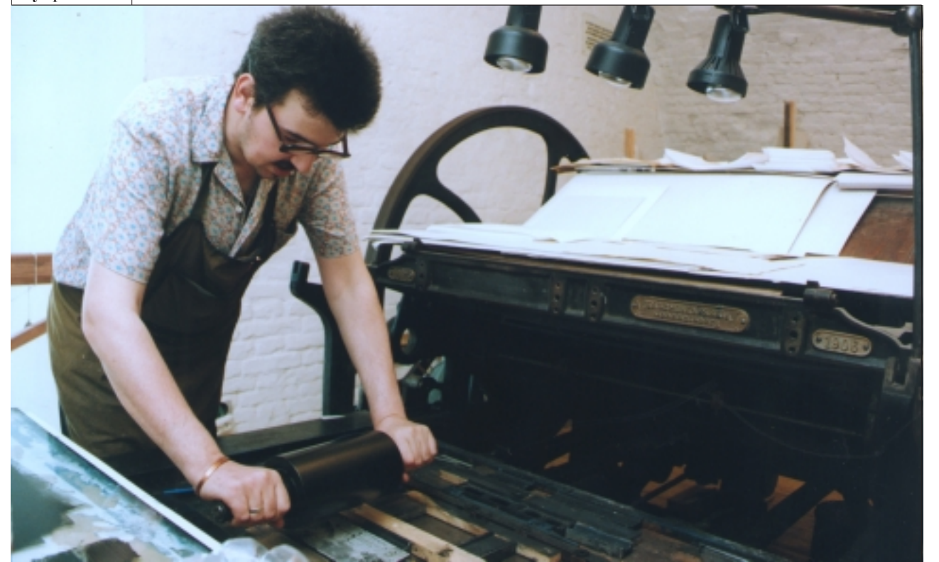
На немецкой машине начала века печатают линогравюры, на станке XIX века (внизу) – литографии.
