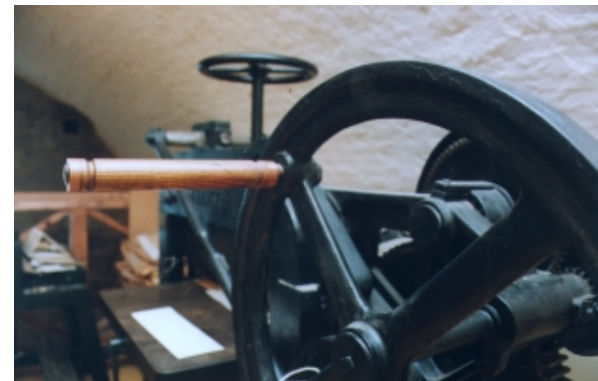
Приспособленная для печати линогравюр немецкая однокрасочная печатная машина начала нашего столетия... и станок для резки цинковых пластин (внизу).
