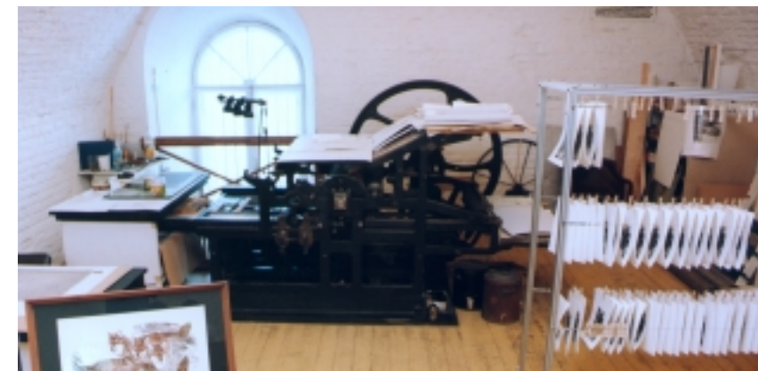
Приспособленная для печати линогравюр немецкая однокрасочная печатная машина начала нашего столетия... и станок для резки цинковых пластин (внизу).
