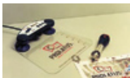
Система Prolatus позволяет привычно "чиркать" на цветопробе электронным карандашом, передавая "пожелания" по сети.
