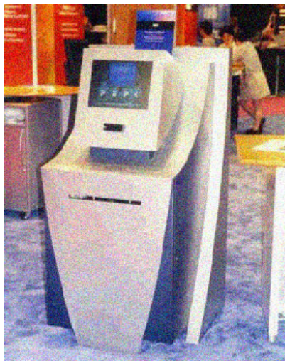
Киоск PEPC. Клиент вставляет кредитную, выбирает газету из списка на сенсорном экране и получает распечатанную версию своей газеты (внизу).
